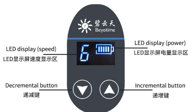
图2. 碧云天BeyoPipet™基础型电动移液器(E6852)操作面板示意图。
